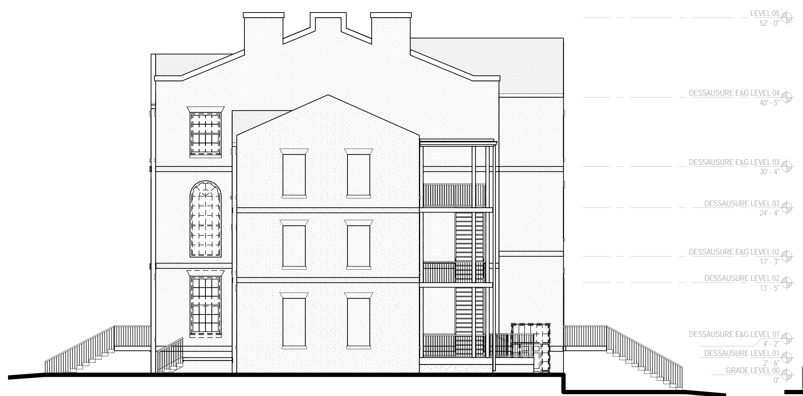
1 ELEVATION - EAST DEMO D301 SCALE: 1/8" = 1'-0"
