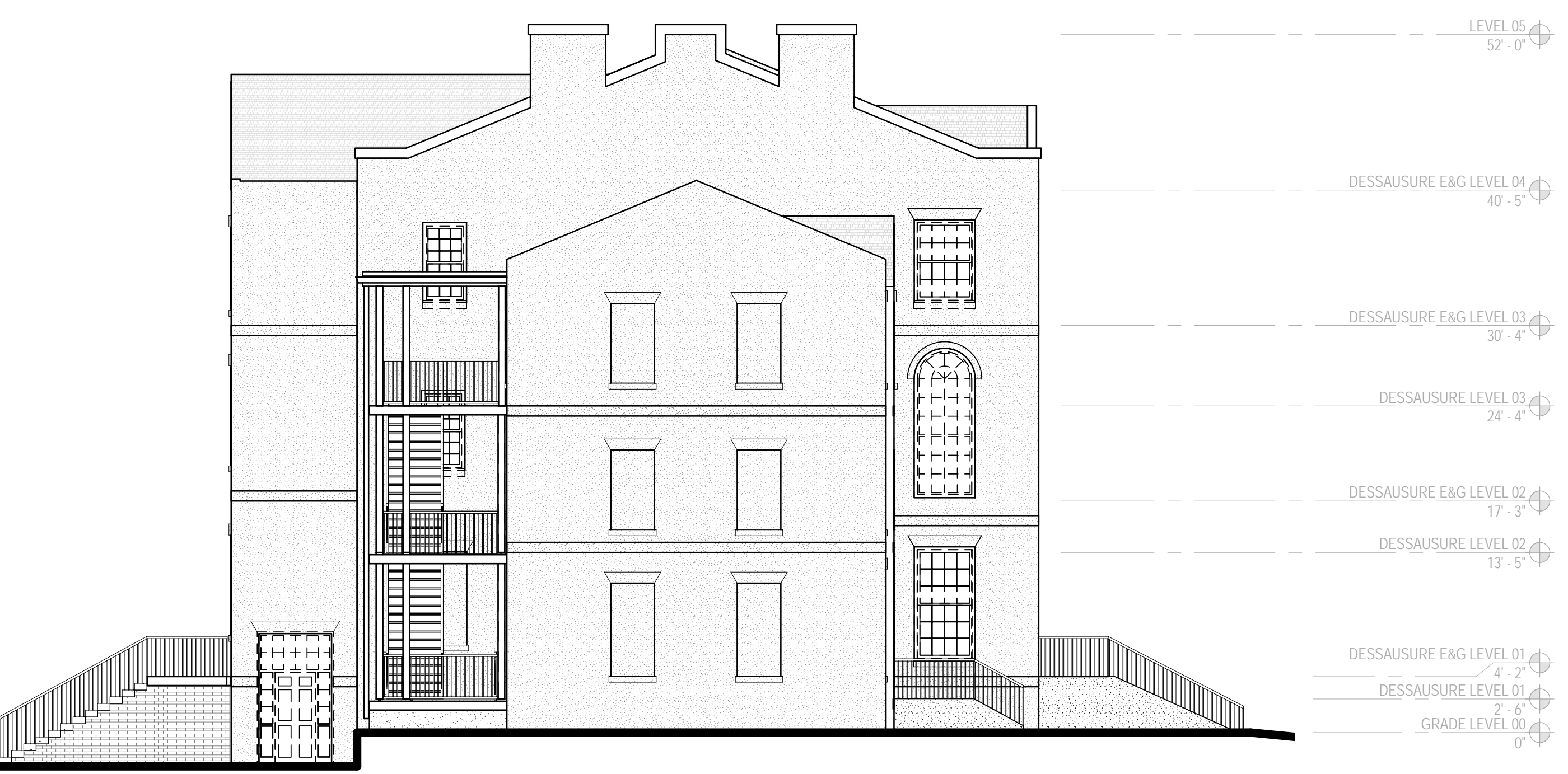
2 ELEVATION - WEST DEMO D301 SCALE: 1/8" = 1'-0"
